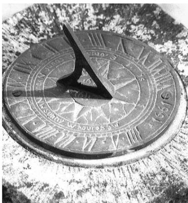
Рис. 2. Солнечные часы, полуденная ось которых смотрит строго на север, показывают точное местное солнечное время. Для правильной ориентации переносных солнечных часов необходимо знать магнитное склонение, т. е. угол между направлением на истинный север и направлением, указываемым стрелкой компаса в данной местности.
