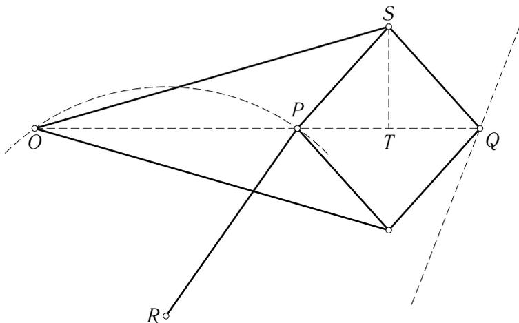
Рис. 58. Инверсор Поселье, преобразующий вращательное движение в прямолинейное
